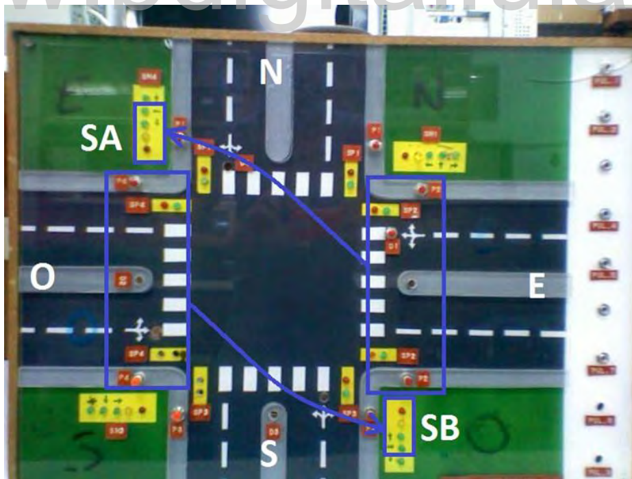
Figura 45. Maqueta usada en la práctica de semáforos.
